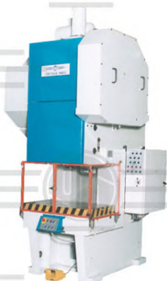
ОРША- 1400 (усилие 140 т) ненаклоняемый
